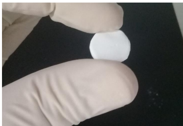
Figura 5 – Híbrido de celulose bacteriana e hidroxiapatita (CB/HA)
