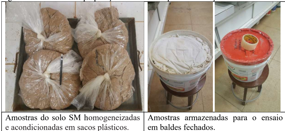
Figura 18 – Detalhes da preparação das amostras para a realização dos ensaios de DP
