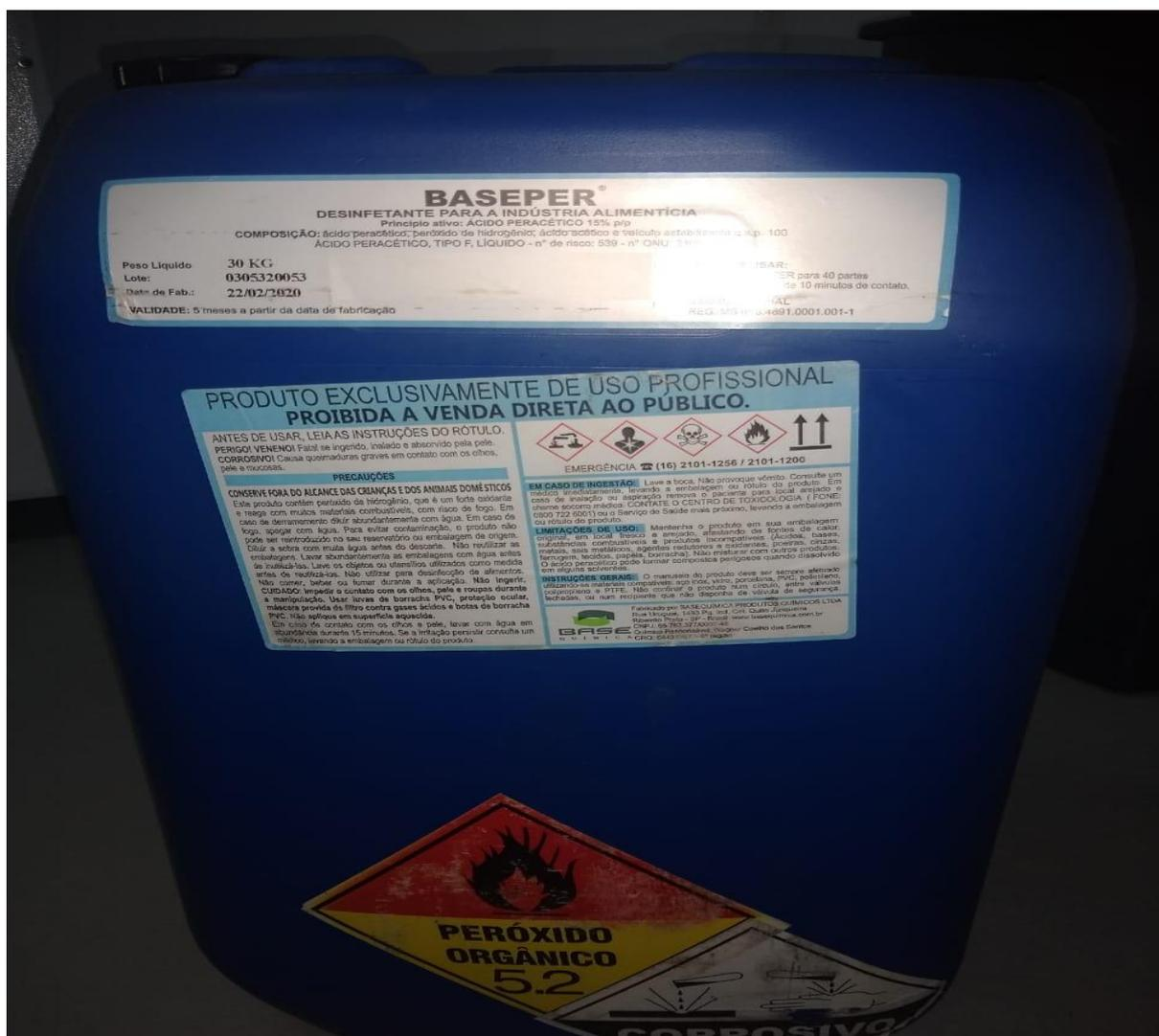
Figura 36. Ácido peracético utilizado no CIP. Fonte: Autoria própria.
