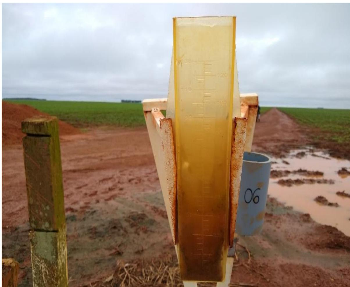
**Figura 24.** Leitura de pluviômetro. Fonte: Autoria própria.
