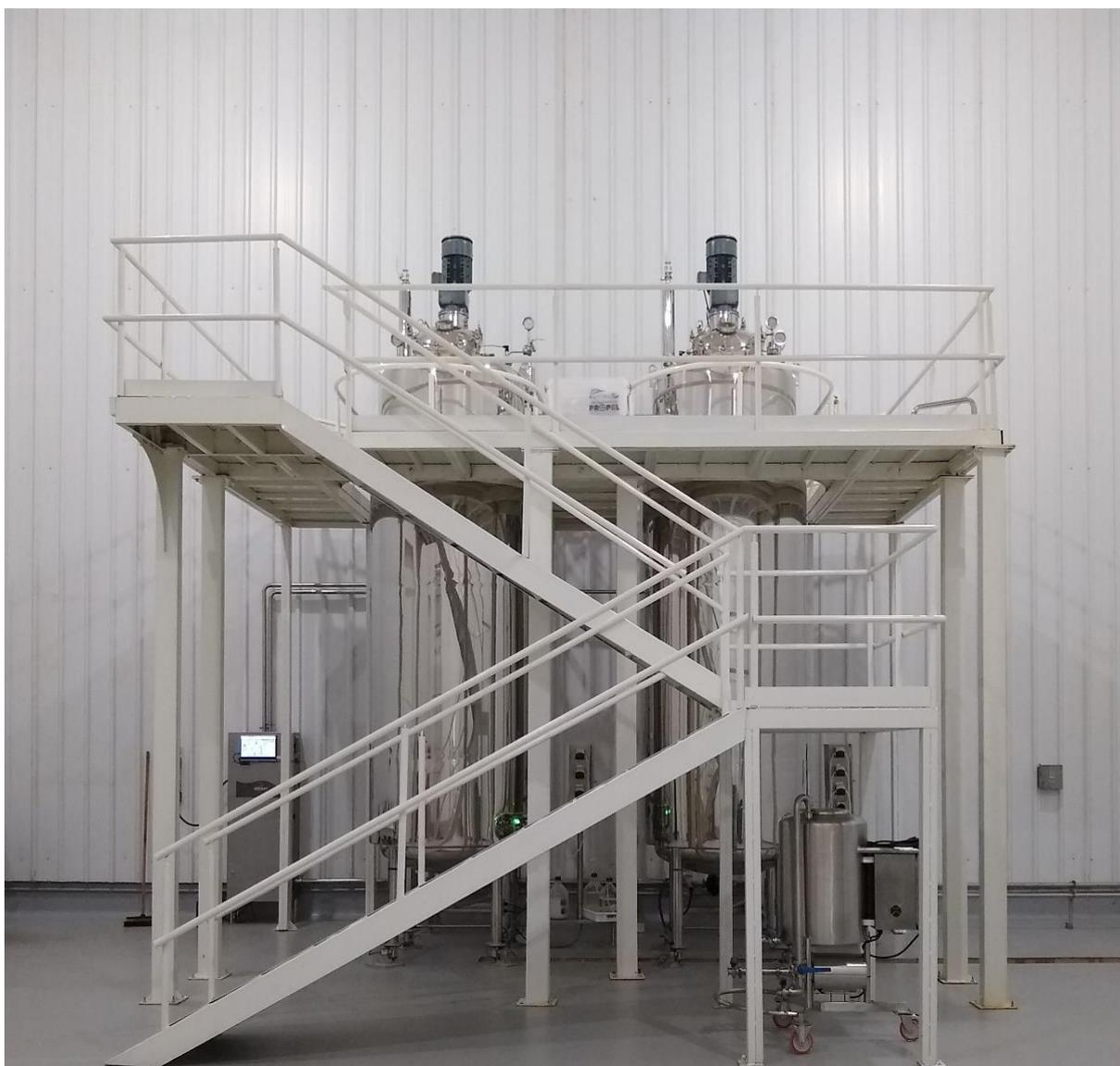
**Figura 28.** Fermentadores AllMic Process SCR-S, Allbiom. Fonte: Autoria própria.
