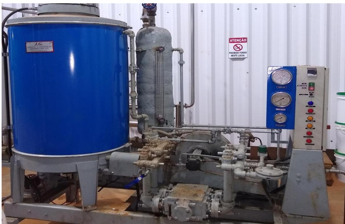
Figura 30. Gerador de vapor. Fonte: Autoria própria.
