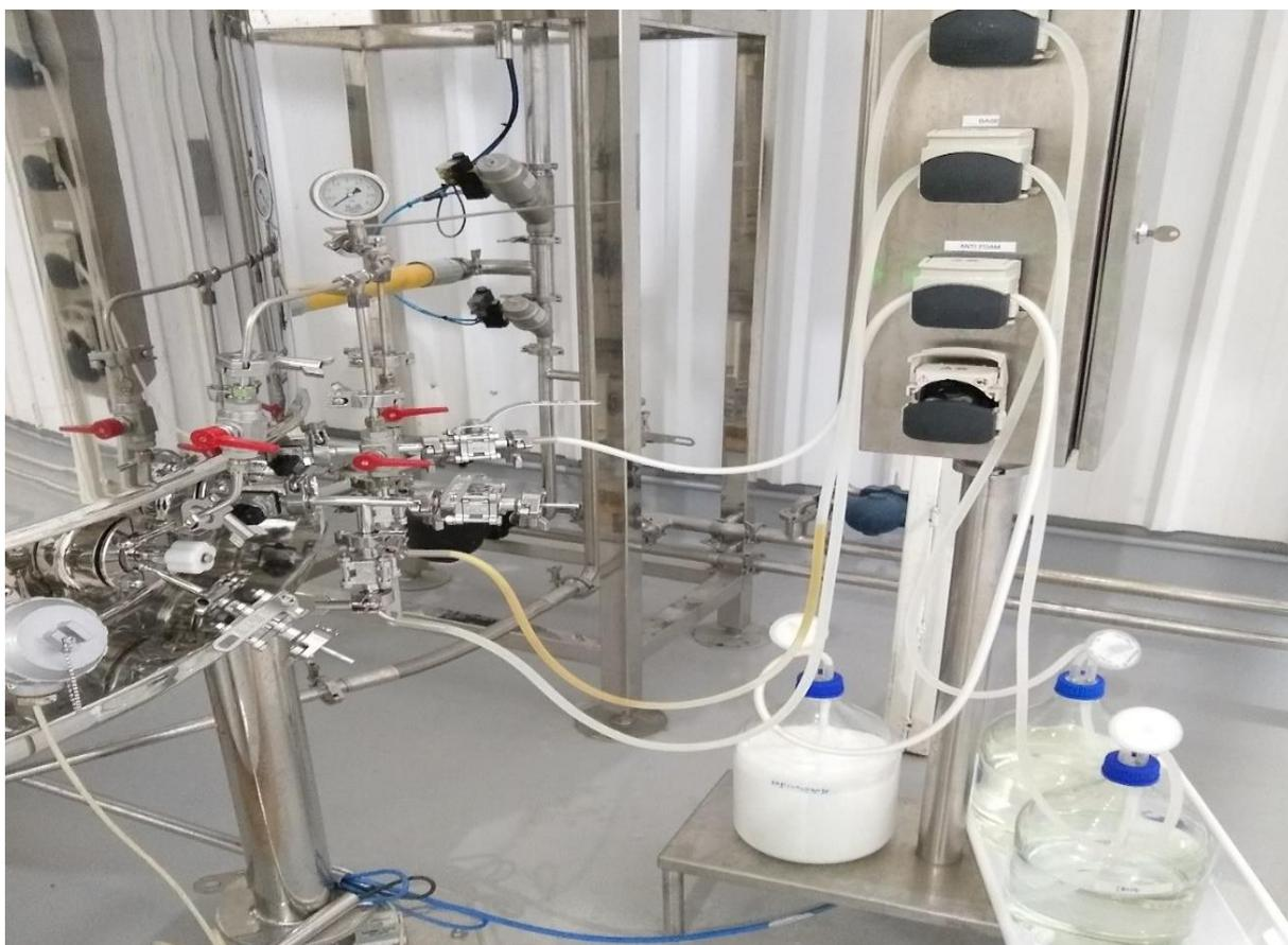
**Figura 42.** Soluções de ácido, base e antiespumante conectadas. Fonte: Autoria própria.
