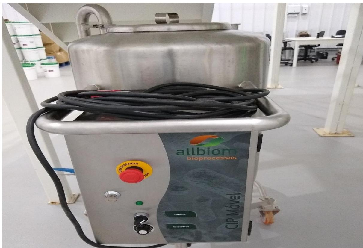
**Figura 34.** Equipamento de CIP móvel. Fonte: Autoria própria.
