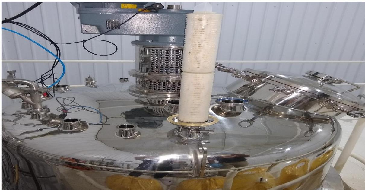
Figura 35. Remoção das peças externas e do filtro do exaustor. Fonte: Autoria própria.
