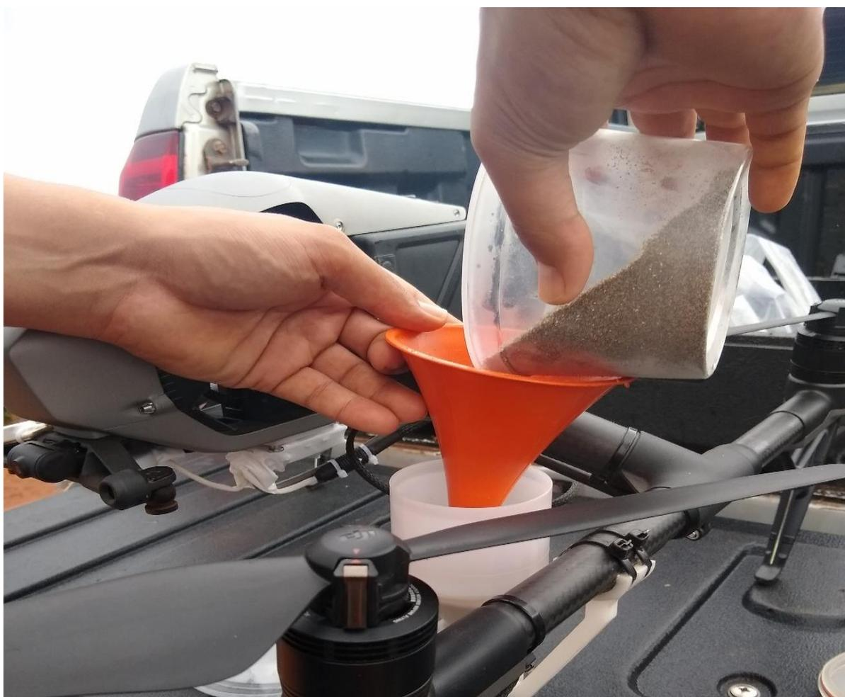
**Figura 50.** Reservatório dispenser do drone. Fonte: Autoria própria.
