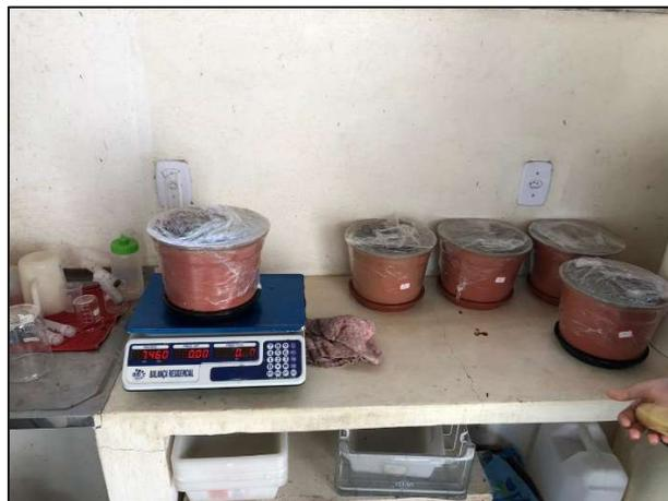
**Figura 1.** Determinação da capacidade de retenção de água.
