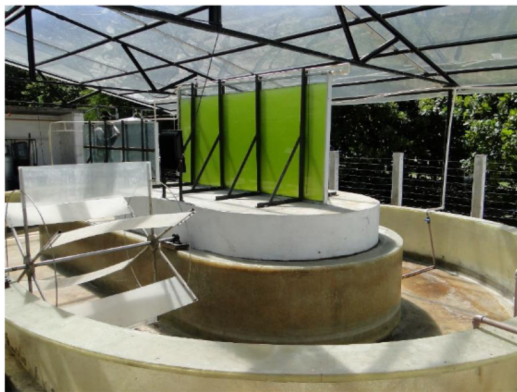
Figura 3. 8 Fotobiorreatores tipo placa plana e piscina de cultivo tipo raceway .
