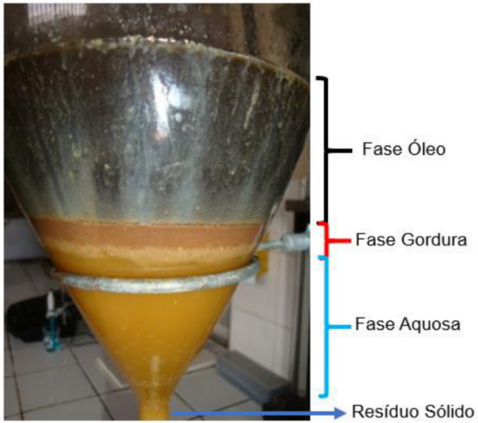
Figura 3.4 Perfil de fases obtido após o processo de cocção e decantação por 24 h.
