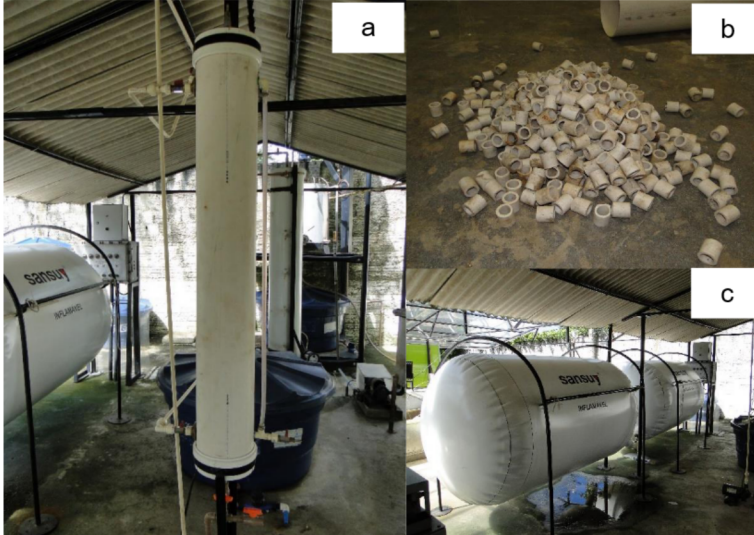
Figura 3.7 Reator de tratamento do biogás (a), material de enchimento, anéis de PVC, e os bags de armazenamento de biometano (c).
