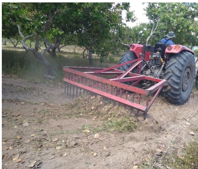
Figura 9 – Uso de ciscagem na eliminação de restos culturais
