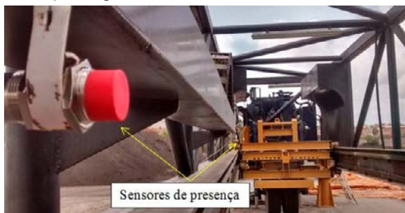
Figura 7 – Sensores de presença para contabilização da passagem do simulador.
