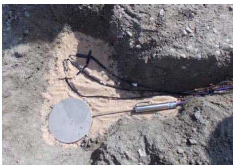
Figura 8 – Exemplo da montagem dos sensores.
