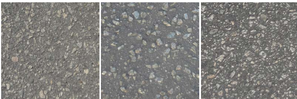
Figura 13 – Misturas asfálticas distintas, com diferentes idades e cores de ligante.
