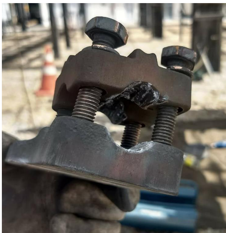
Figura 9 – Conector com sinais de desgastes
