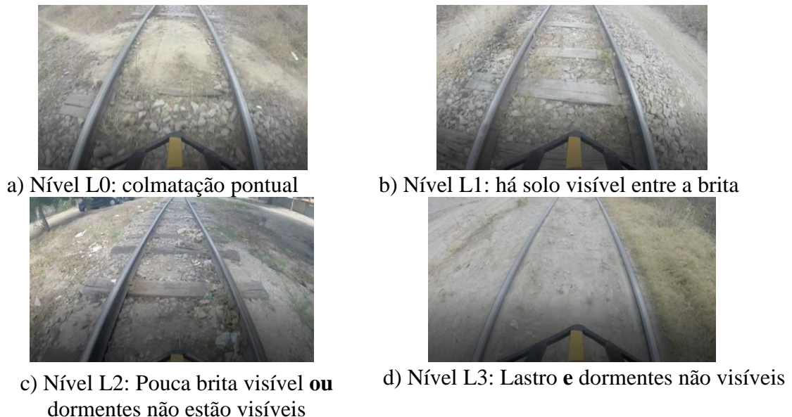
Figura 5: Níveis de severidade sugeridos para o lastro (Fonte: Elaborado pela autora)
