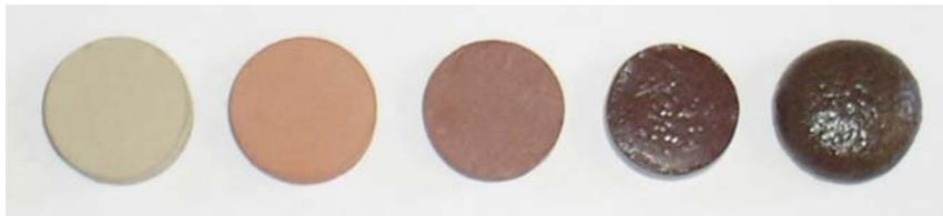
Figura 1: da esquerda para a direita: amostra a verde, sinterizada a  $1050\text{ }^\circ\text{C}$ , a  $1100\text{ }^\circ\text{C}$ , a  $1150\text{ }^\circ\text{C}$  e a  $1250\text{ }^\circ\text{C}$  (pó de granito Rain Forest)<sup>(10)</sup>
