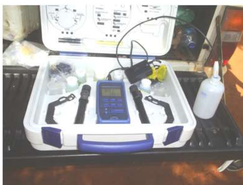
Figura 16 – Alguns equipamentos utilizados em campo: condutivímetro, phmetro portátil e medidor de nível.
