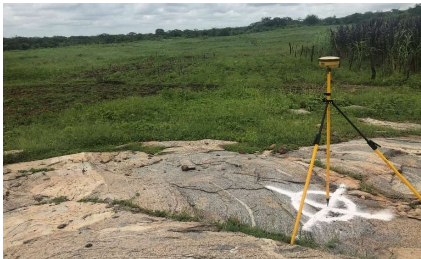
Figura 56 – Receptor GPS, marcando pontos de controle visíveis a 100m de altura.
