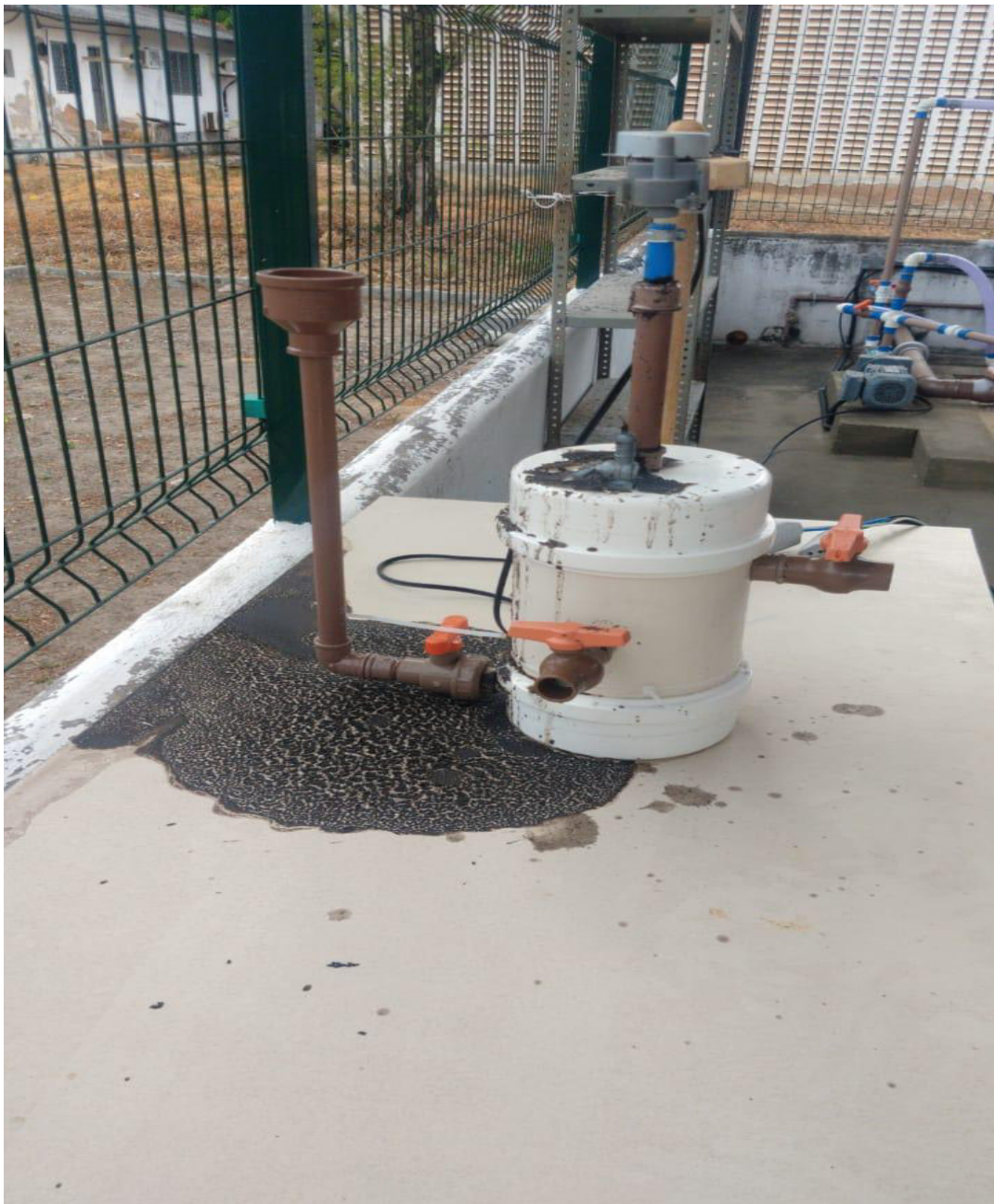
Figura 5 – Fotografia do reator utilizado nos experimentos de biodigestão.
