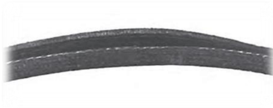
Figura 13- Separação na dobra da correia, indicando uso de polia de diâmetro menor do que o recomendado.
