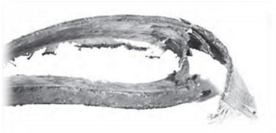
Figura 12 - Decapagem da camada externa e falha prematura da correia, indicando combinação de poeira em excesso e acabamento grosseiro das polias.
