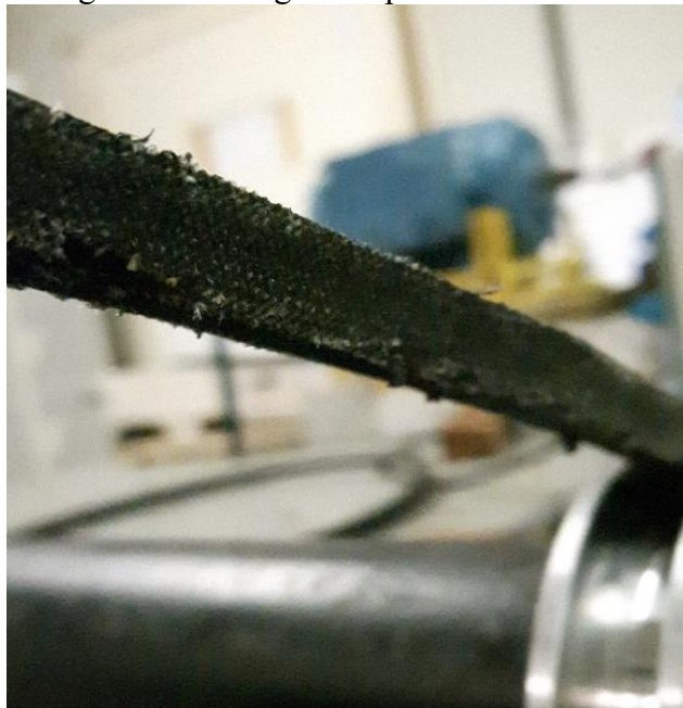
Figura 29 – Desgaste superficial na correia
