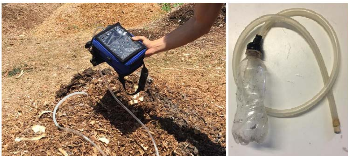
Figura 1- Medição dos gases e sistema de drenagem para leira E100
