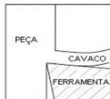
Figura 1 – Remoção de material
