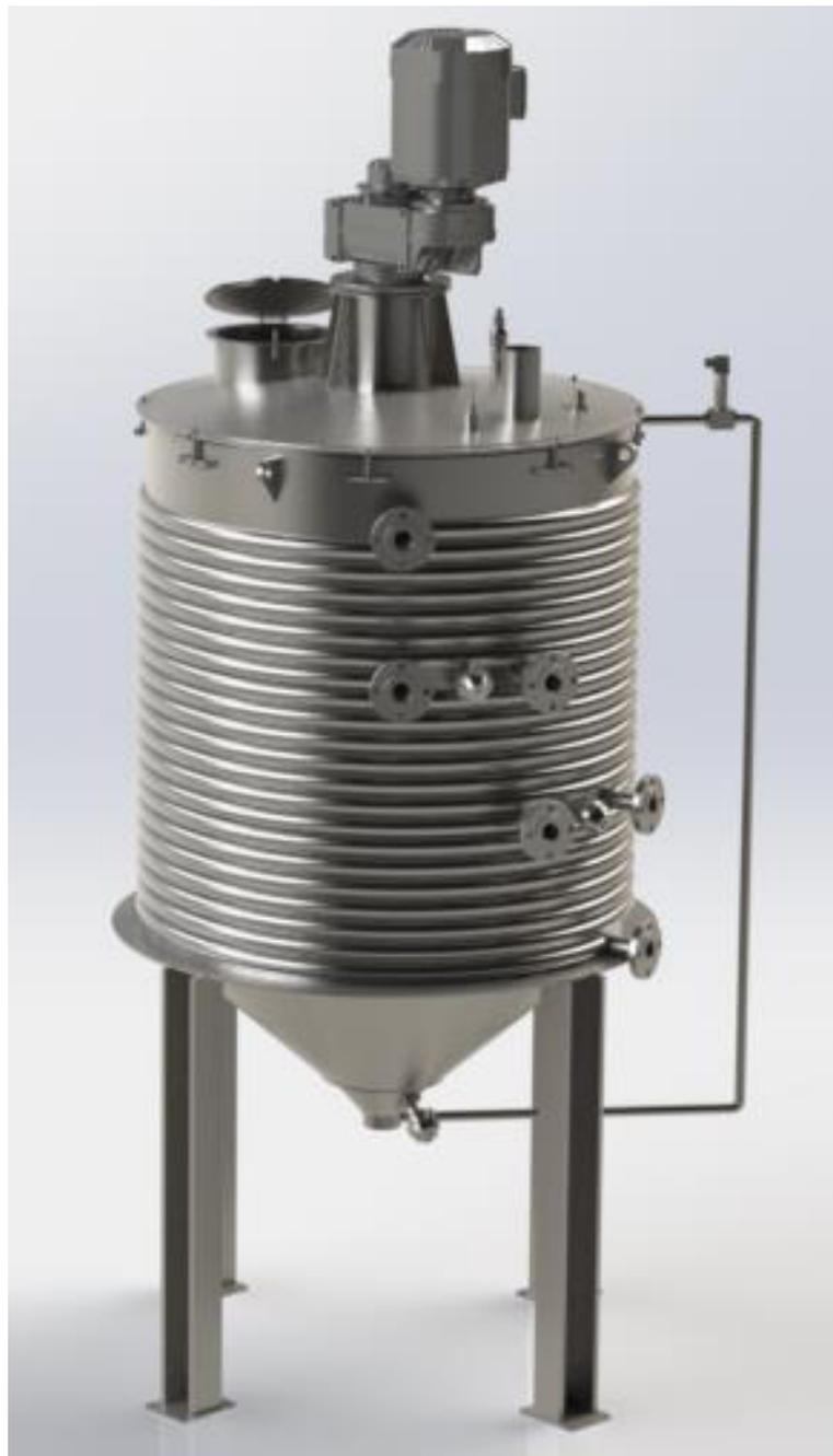
Figura 20 - Modelo 3D do tanque agitado. Fonte: Elaborado pelo autor
