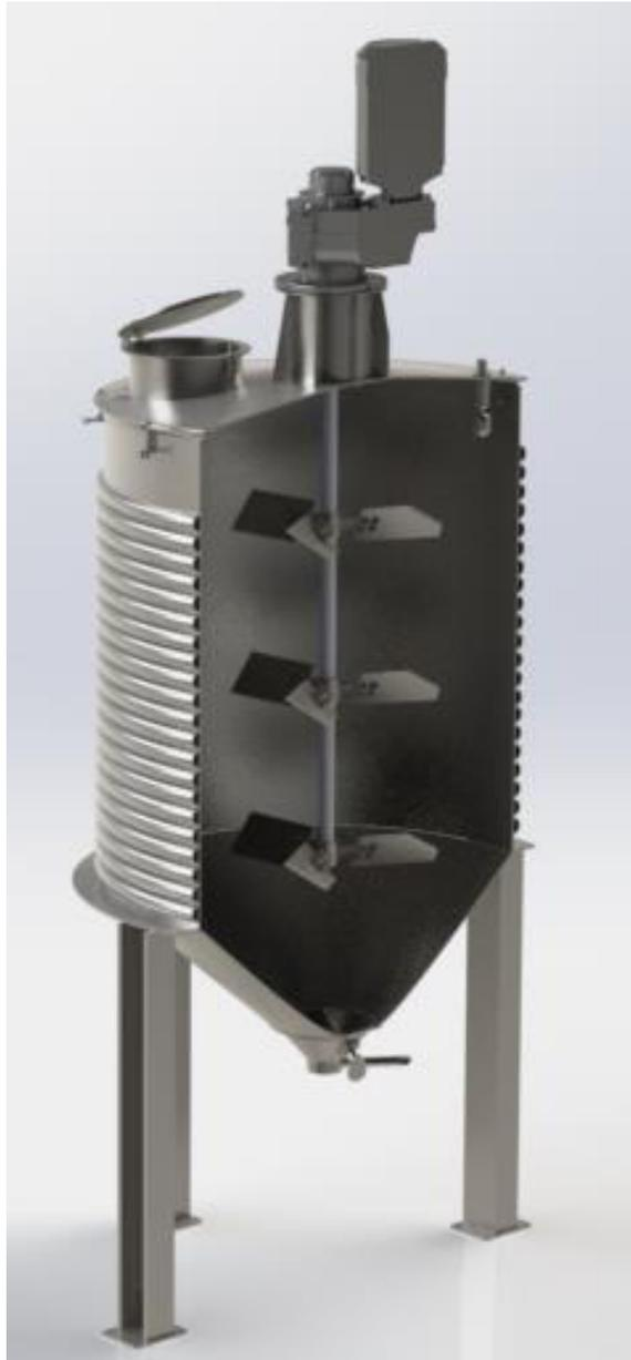
Figura 21 - Vista em corte do tanque agitado. Fonte: elaborado pelo autor
