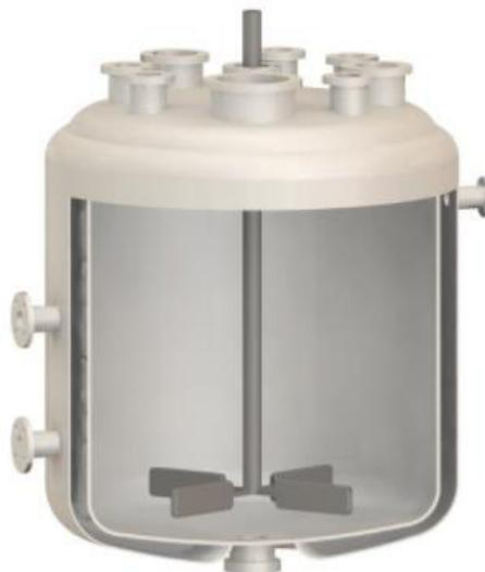
Figura 6 - Agitador rotativo. Fonte: Wikipédia
