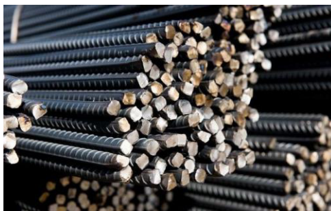
Figura 13 – Vergalhões de aço
