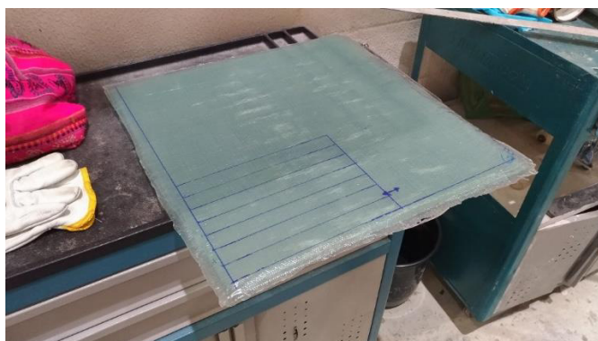
Figura 23. Laminado preparada para ser cortado.
