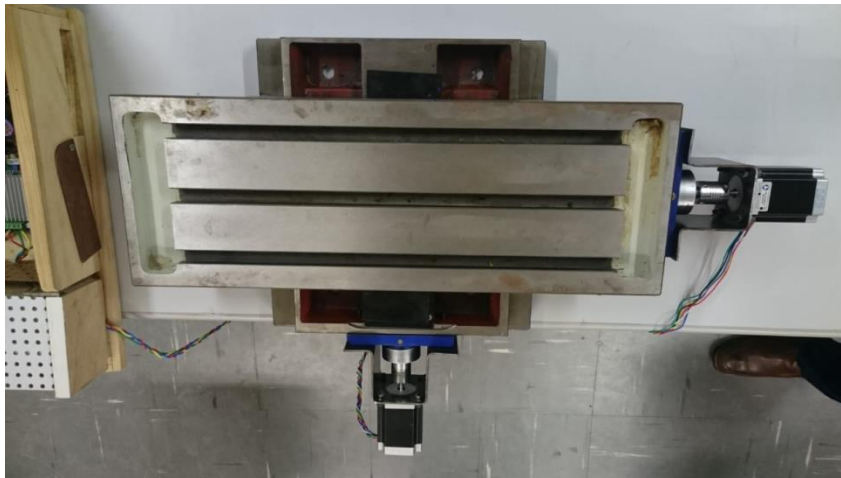
Figura 42 – Vista superior da mesa de coordenada automatizada com os motores de passo
