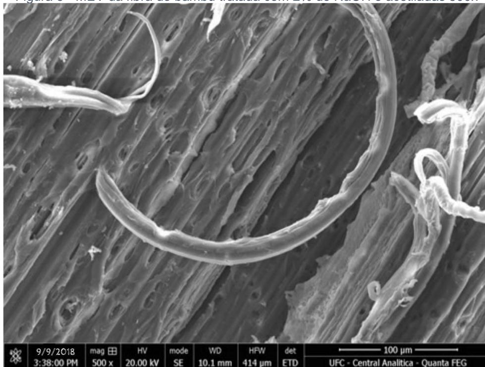
Figura 10 - MEV da fibra de bambu tratada com 2% de NaOH e acetiladas 100x
