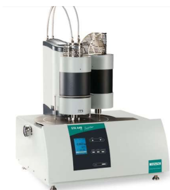
Figura 21: Equipamento de análise simultânea (TG/DSC) Jupiter STA 449 Netzsch
