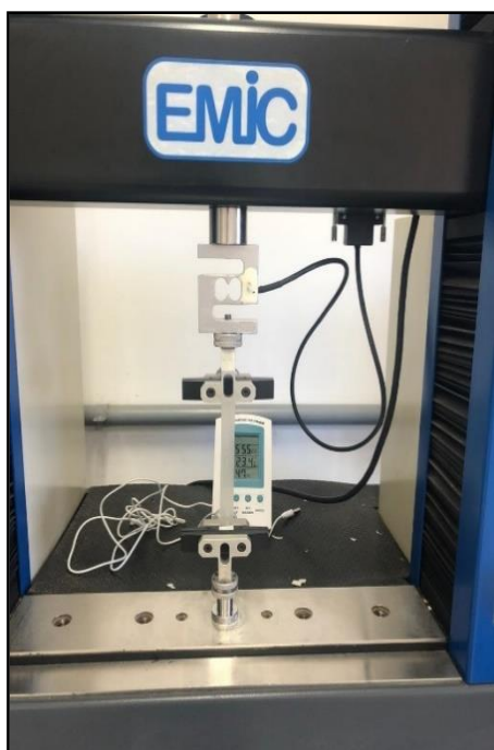
Figura 10 – Corpo de prova acoplado ao equipamento do (EMIC)
