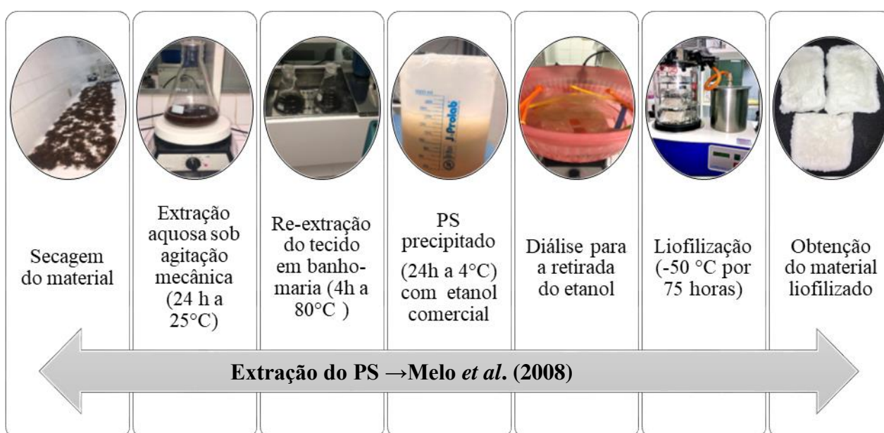
Figura 5 – Fluxograma do processo de extração do polissacarídeo sulfatado da alga vermelha Hypnea musciformis .
