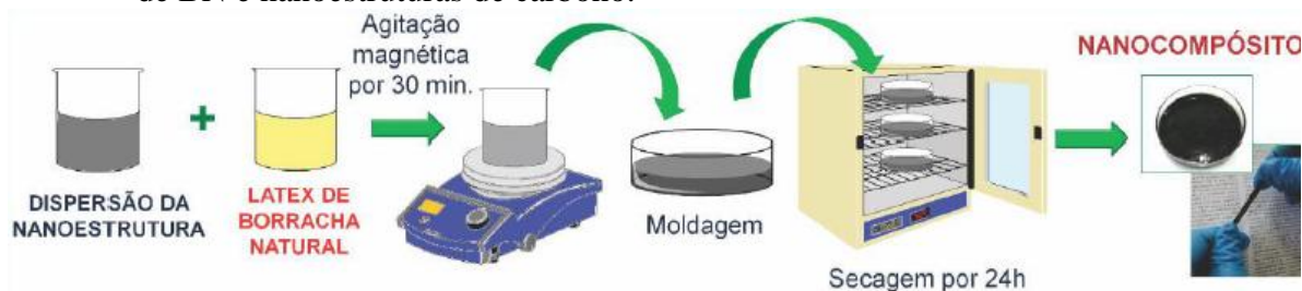
Figura 19 – Ilustração do processo de síntese de nanocompósitos de látex de BN e nanoestruturas de carbono.
