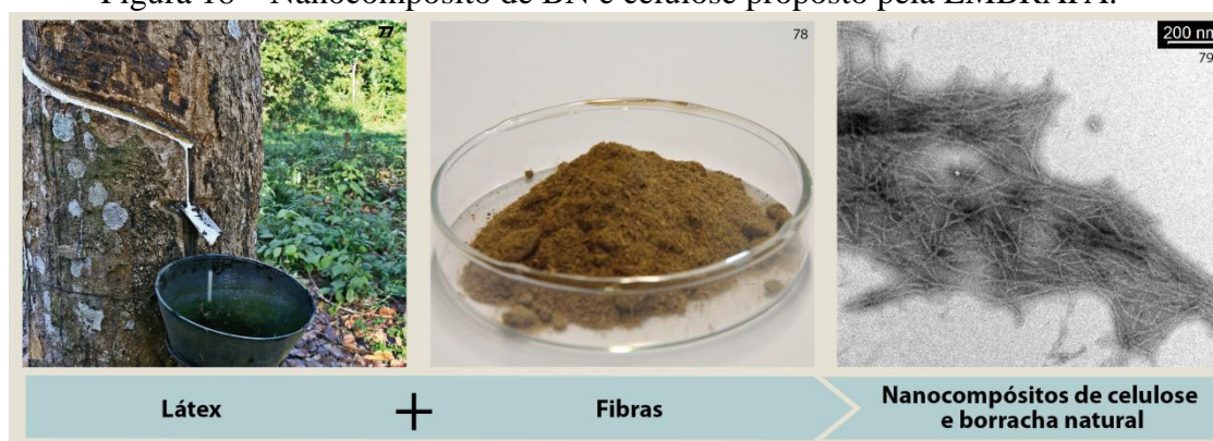
Figura 18 – Nanocompósito de BN e celulose proposto pela EMBRAPA.
