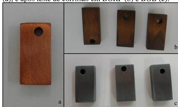
Figura 11 - Lâminas de cobre, antes do teste de corrosão (a), e após teste de corrosão em BORF (b) e BOB (c).
