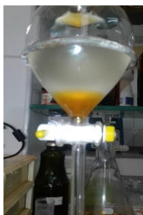
Figura 5 - Etapa de separação das fases éster (superior) e glicerina (inferior).
