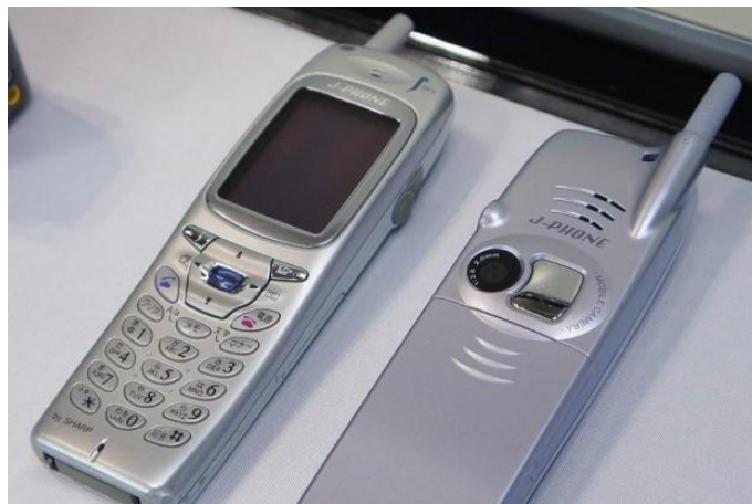
Figura 6 – Sharp J-SH04, primeiro celular com câmera integrada
