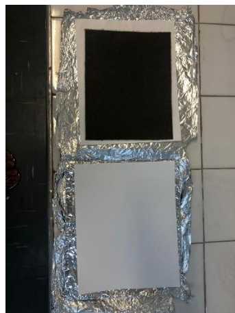
Figura 12 - Filtro de fibra de vidro com a amostra de MP e limpo
