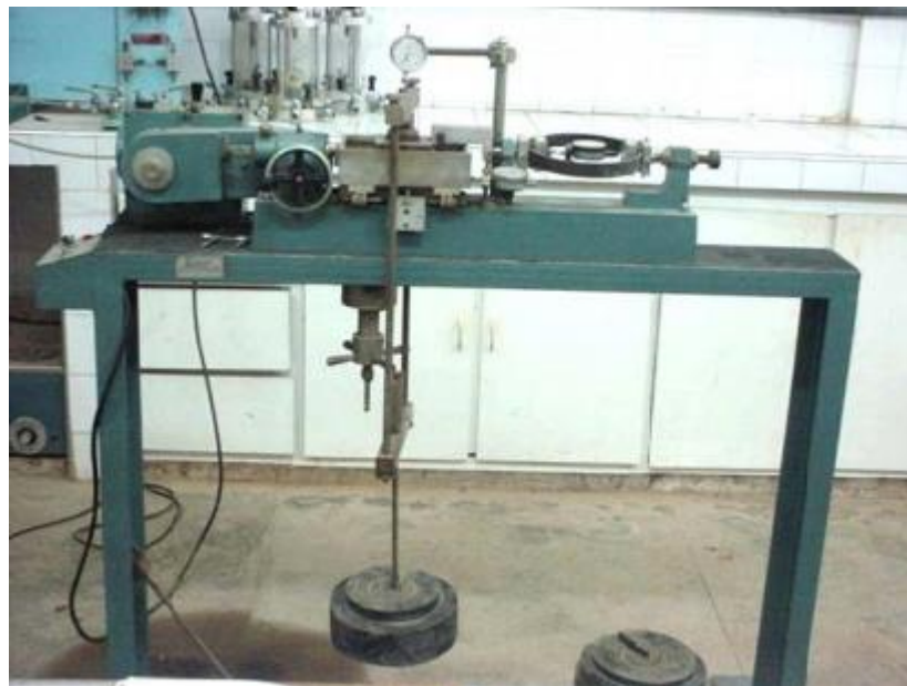
Figura 09 — Maquinário utilizado para o ensaio de cisalhamento direto
