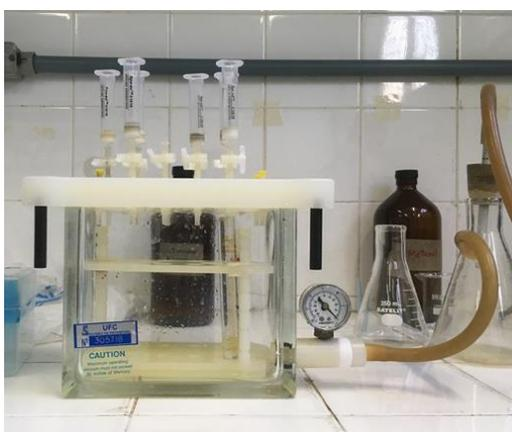
Figura 13 – Sistema utilizado para a extração em fase sólida (Fonte: autor).
