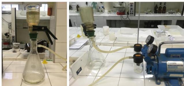
Figura 12 – Sistema utilizado para a etapa de filtração das amostras de água (Fonte: autor).
