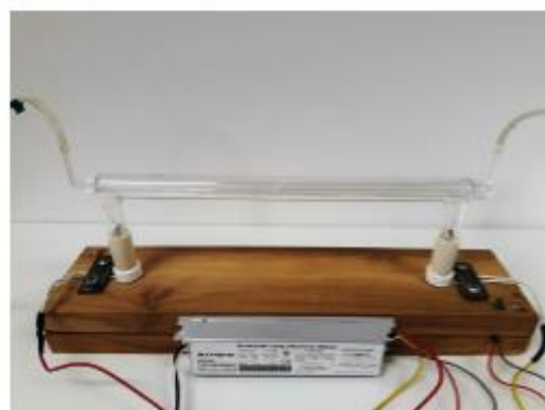
Figura 7 – Reatores Fotoquímicos: (A) reator de 19 W de fluxo interno; (B) reator de 19 W com percurso de PTFE; (C) reator de 15 W com percurso de quartzo; (D) reator de 15 W com percurso de PTFE.
