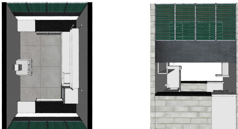
FIGURA 43 Cozinha do tipo 2, frente dupla - planta baixa e perspectiva Fonte: Elaborado pela autora.
