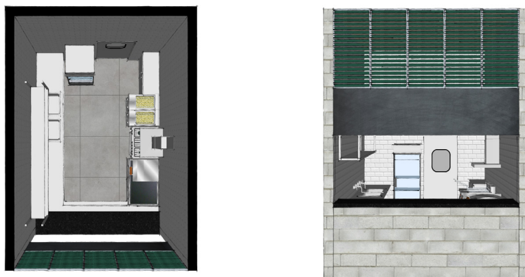
FIGURA 42 Cozinha do tipo 1, frente única - planta baixa e perspectiva Fonte: Elaborado pela autora.
