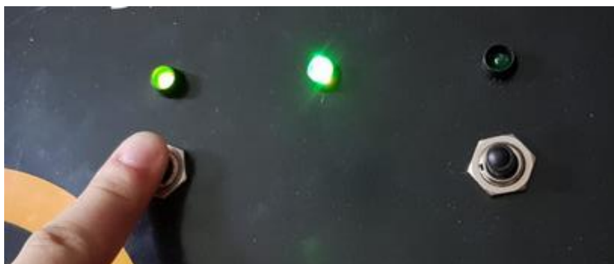
Figura 61 – RGB central verde indicando a carga e LED esquerdo aceso indicando o botão esquerdo apertado.
