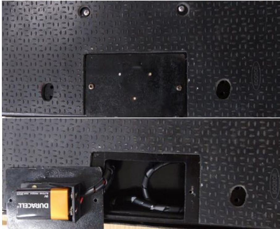
Figura 58 – Detalhe da troca de bateria.
