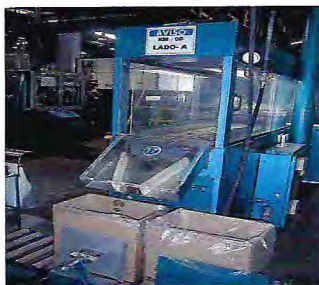
Figura 4.14 – Cabine final onde as rolhas são direcionadas para as caixas
