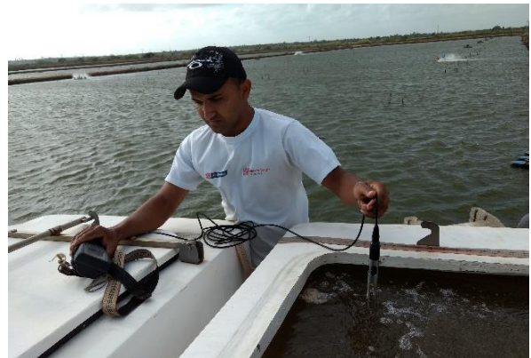
Figura 18 – Medição de oxigênio e temperatura das caixas isotérmicas de transporte.
