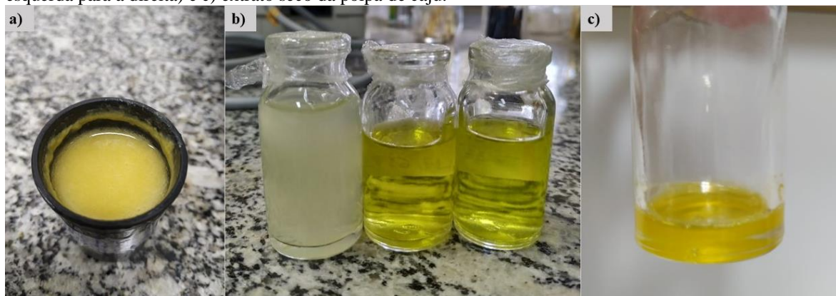
Figura 11. Etapas da extração a) polpa de caju; b) extratos metanólicos da primeira à terceira extração (da esquerda para a direita) e c) extrato seco da polpa de caju.
