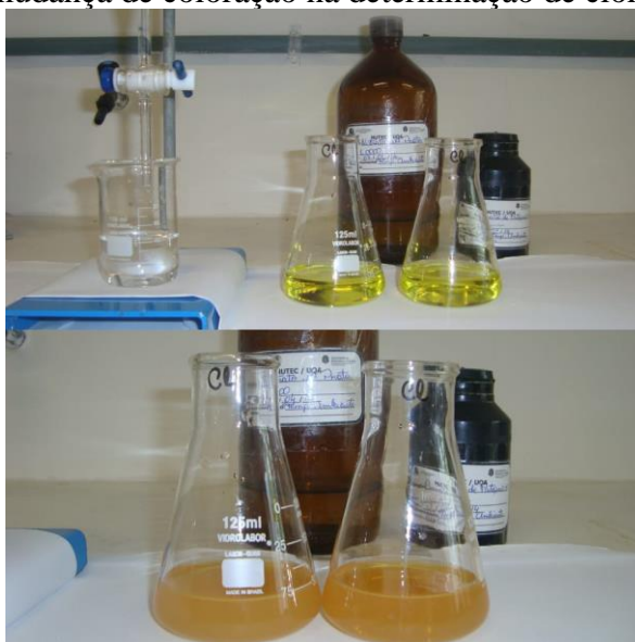
Figura 20 - Ponto final da titulação através da mudança de coloração na determinação de cloreto
