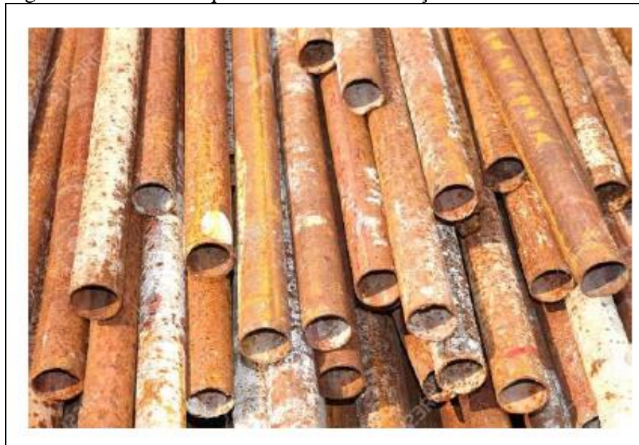
Figura 14 – Corrosão química em uma tubulação
