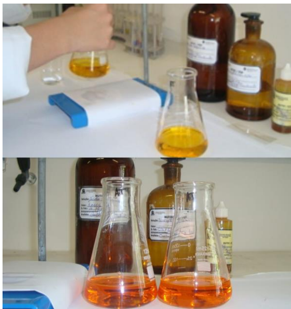
Figura 27 – Mudança de cor no ponto final da determinação da alcalinidade total.
