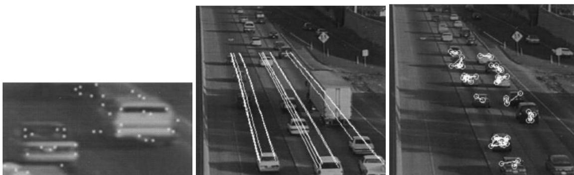
Figura 7 - À esquerda, detecção de pontos. Ao centro, rastreamento dos pontos detectados. À direita, hipóteses veiculares para agrupamento (Beymer *et al.*, 1997)
