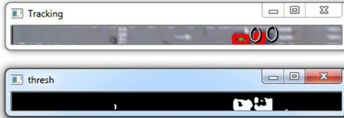
Figura 13 - Superior: veículo na região de interesse. Inferior: subtração de fundo (Autor)
