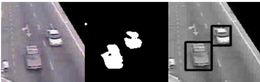
Figura 5 - À esquerda, imagem original. Ao centro, subtração de fundo. À direita, detecção veicular (Câmara *et al.*, 2015)
