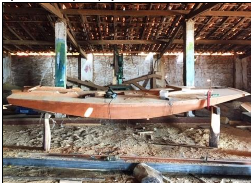
Figura 6 – Fabricação de jangada em estaleiro da comunidade de Redonda
