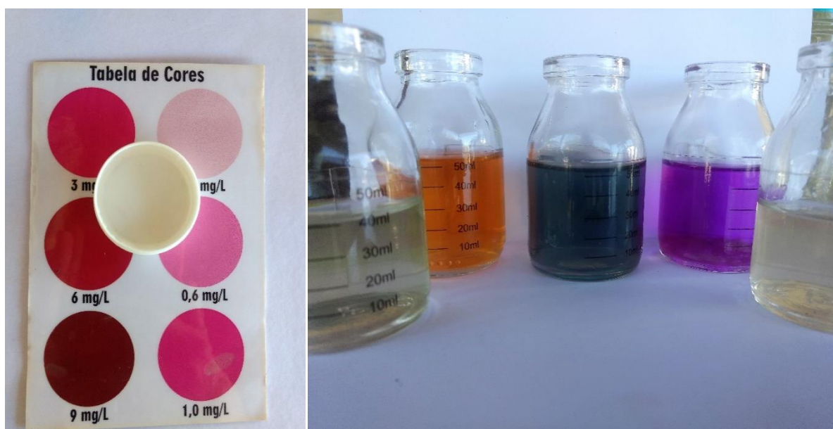
Figura 16 - Análise de água para determinação dos parâmetros químicos utilizando teste colorimétrico.
