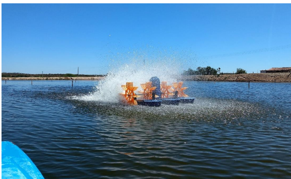
Figura 14 - Aeradores em funcionamento na Fazenda Aconchego.
