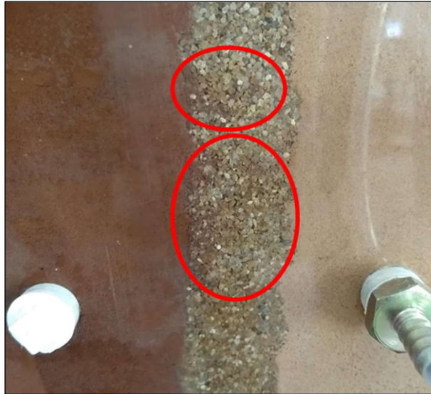
Figura 56 – Filtro vertical com partículas de solo base retidas
