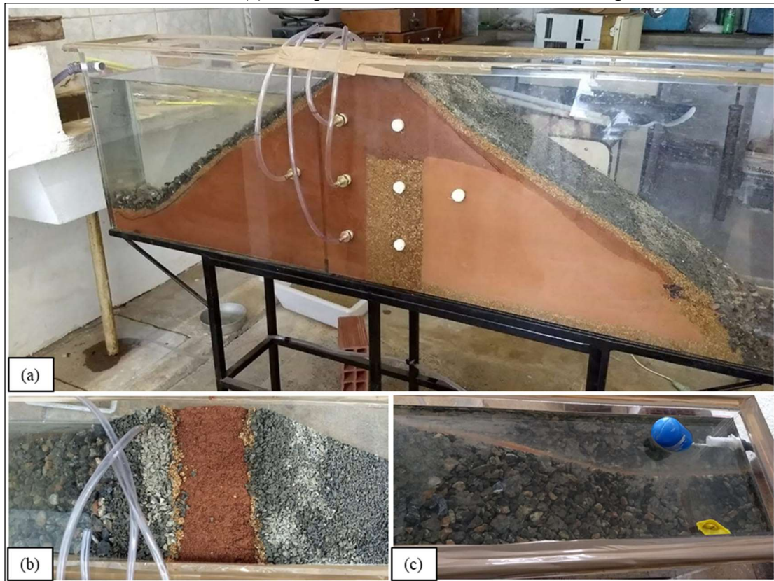
Figura 52 – Modelo experimental de barragem de terra (a) finalizado com (b) os detalhes do coroamento e (c) o dispositivo de controle do nível de água
