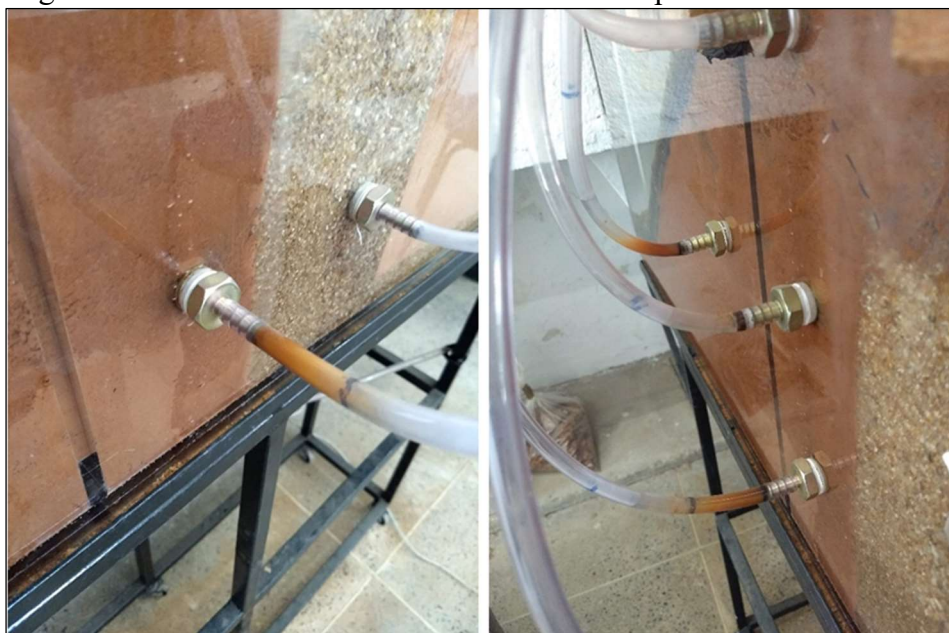
Figura 59 – Partículas finas “soltas” invadindo os piezômetros instalados
