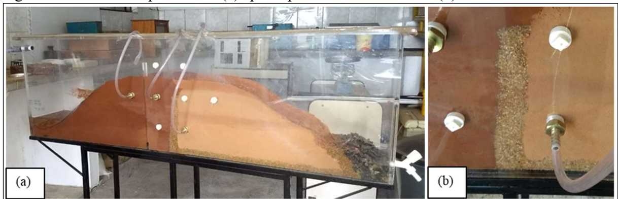
Figura 48 – Modelo experimental (a) após o primeiro enchimento e (b) detalhe do filtro vertical
