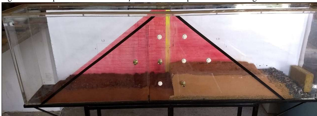
Figura 46 – Etapas iniciais da construção do modelo experimental de barragem de terra
