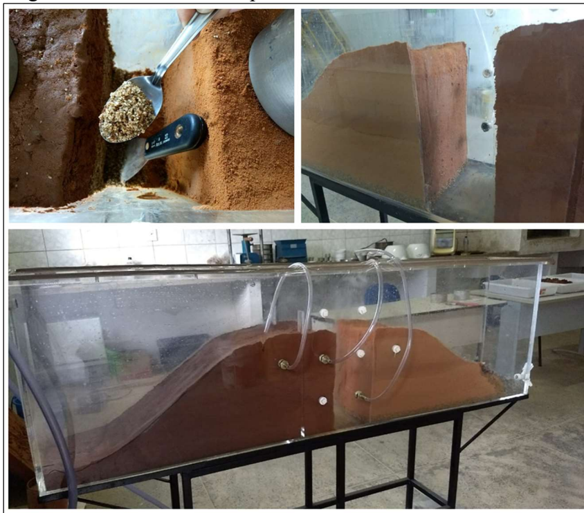
Figura 50 – Aumento da espessura do filtro vertical
