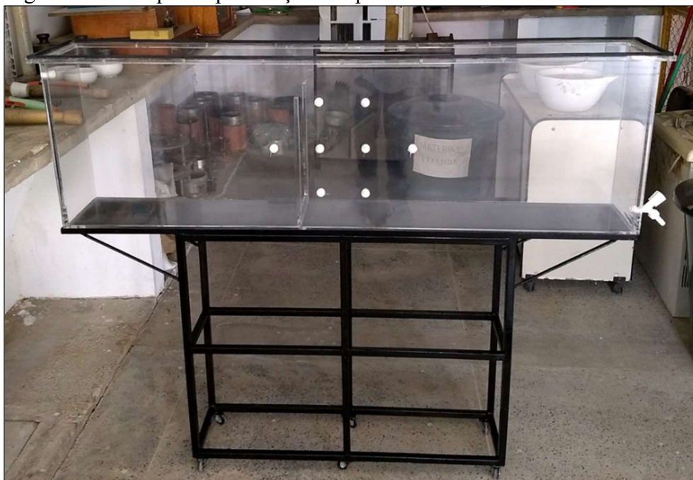
Figura 42 – Tanque de percolação e suporte metálico
