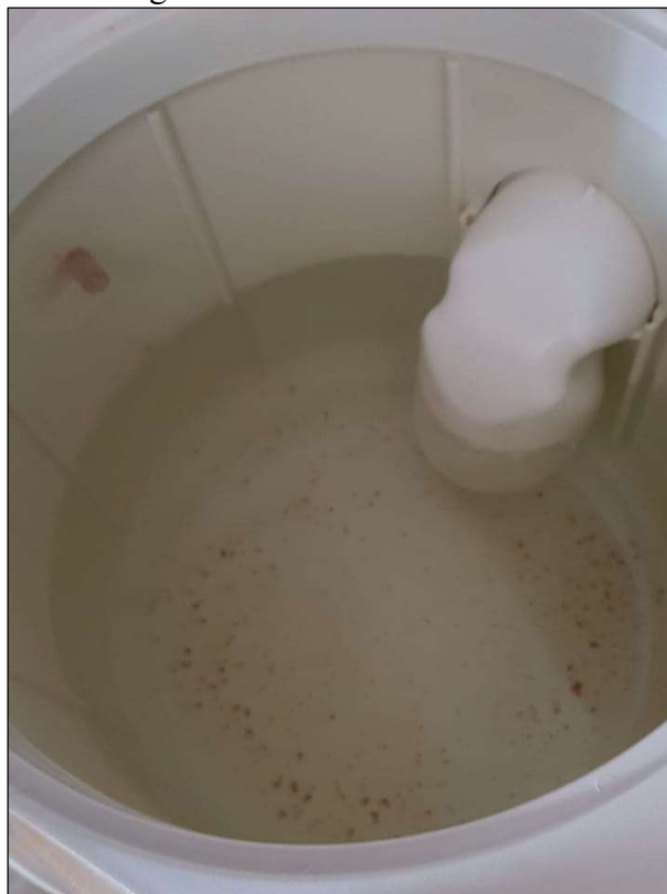
Figura 60 – Partículas de solo carregadas pelo fluxo de água
