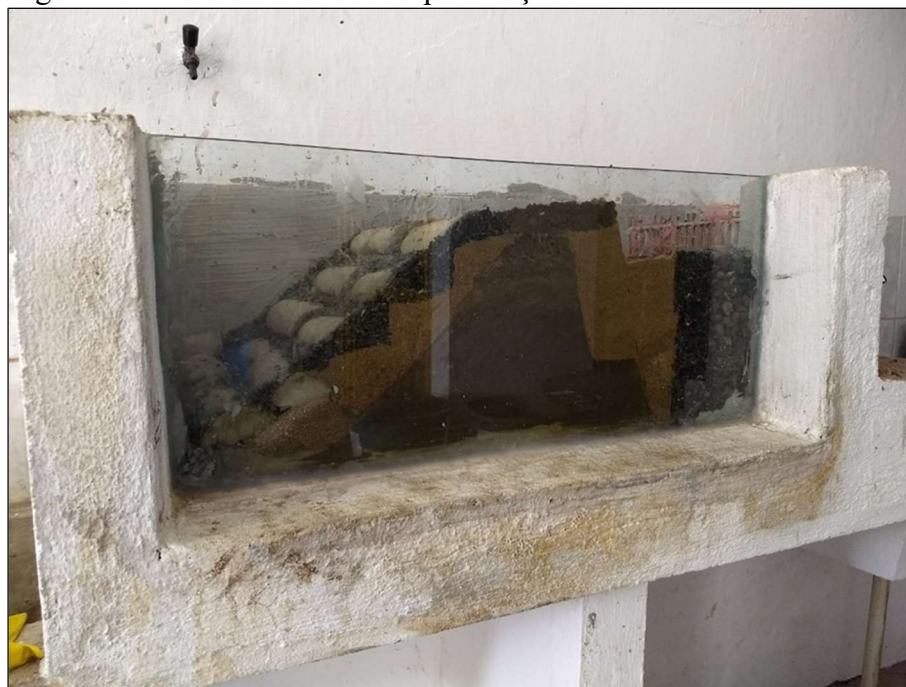
Figura 38 – Modelo da calha de percolação construído
