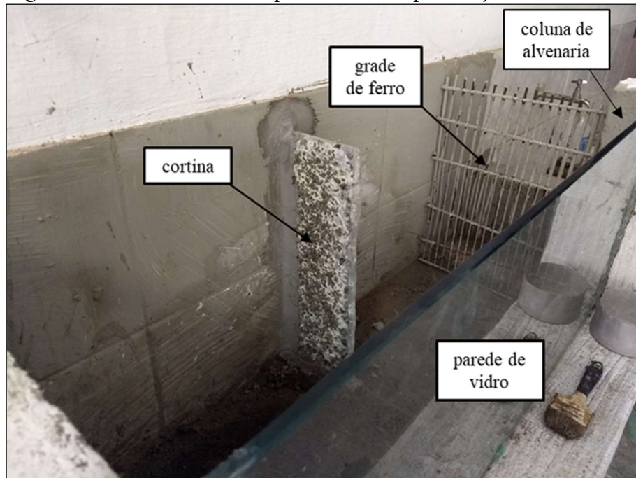
Figura 36 – Estrutura externa para a calha de percolação
