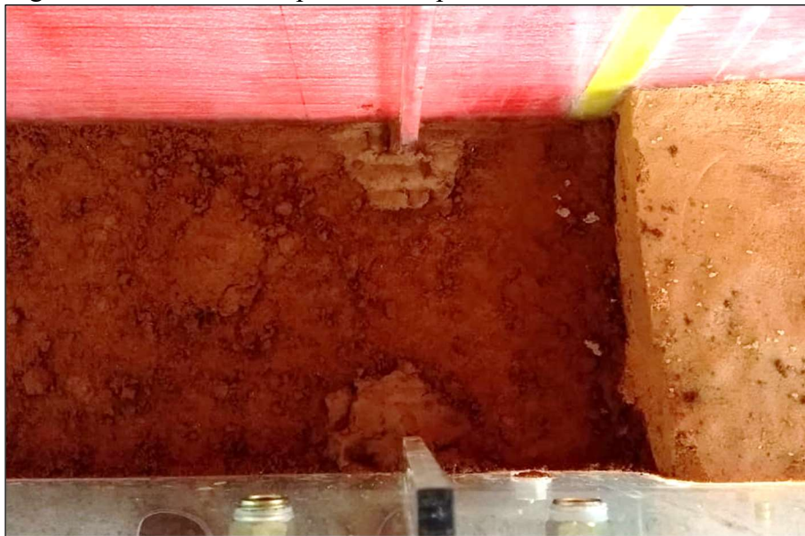
Figura 47 – Material compactado nas proximidades da interface
