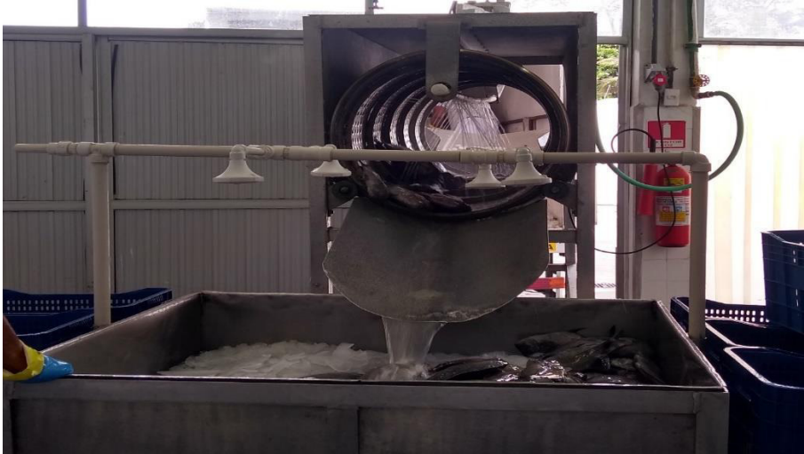
Figura 2 - Cilindro de lavagem de aço inox na plataforma de recepção de peixe fresco.
