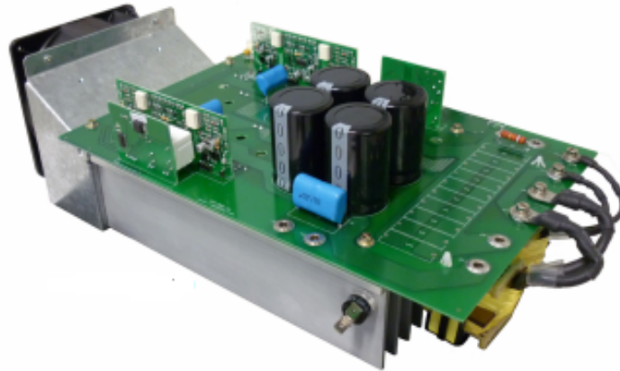
Figura 27 – Conversor comercial utilizado para implementar o filtro ativo shunt .
