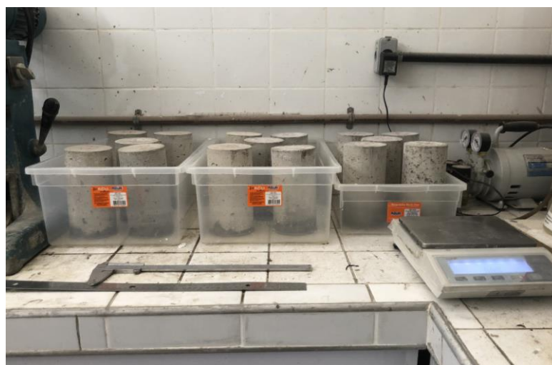
Figura 9 – Execução do ensaio de absorção de água por capilaridade
