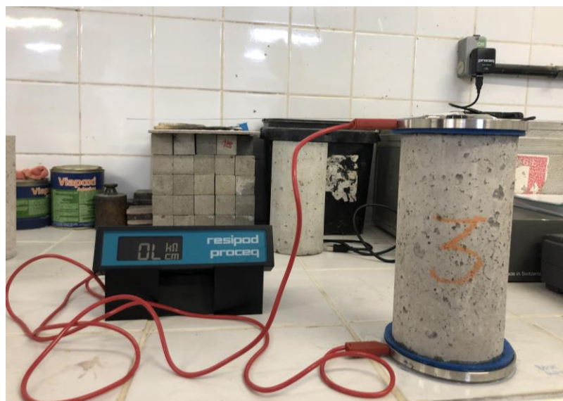
Figura 12 – Equipamento de ensaio Resipod Resistividade Volumétrica
