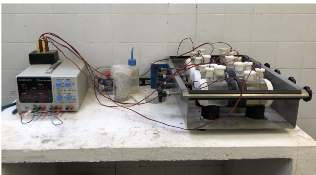
Figura 11 – Aparelhagem do ensaio de penetrabilidade de cloretos
