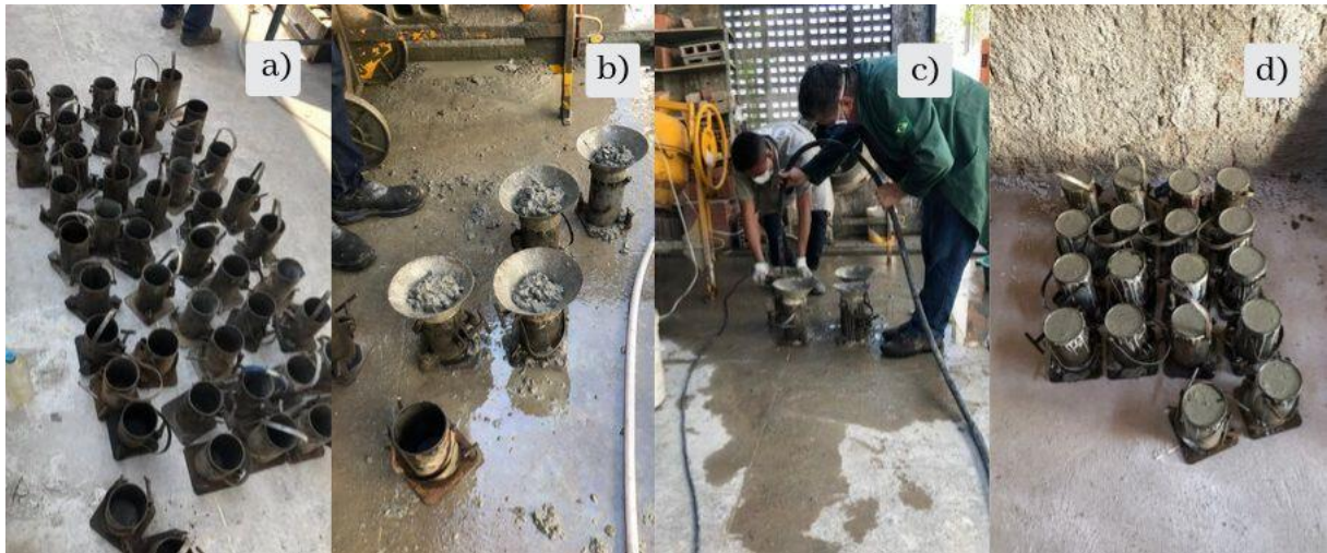
Figura 5 – Moldagem dos CPs. a) Preparação das fôrmas; b) Colocação de concreto nas fôrmas; c) Uso de vibrador mecânico para vibração nos CPs; d) CPs moldados.
