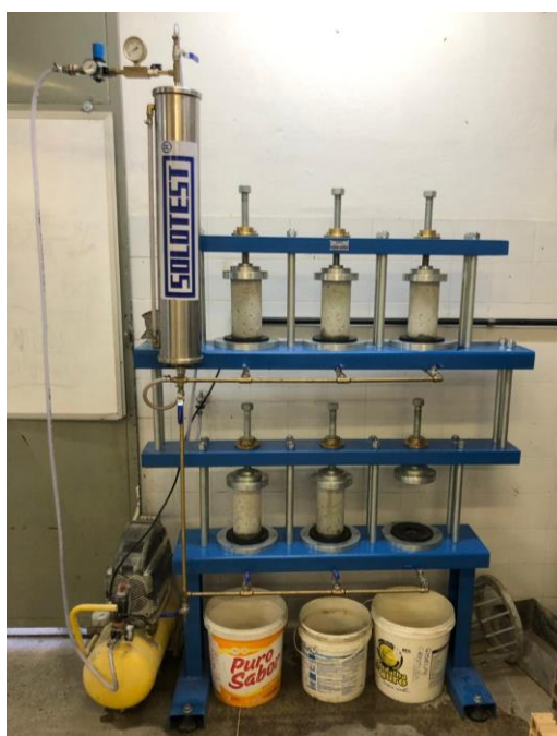
Figura 10 – Corpos de prova em ensaio de penetração de água sob pressão
