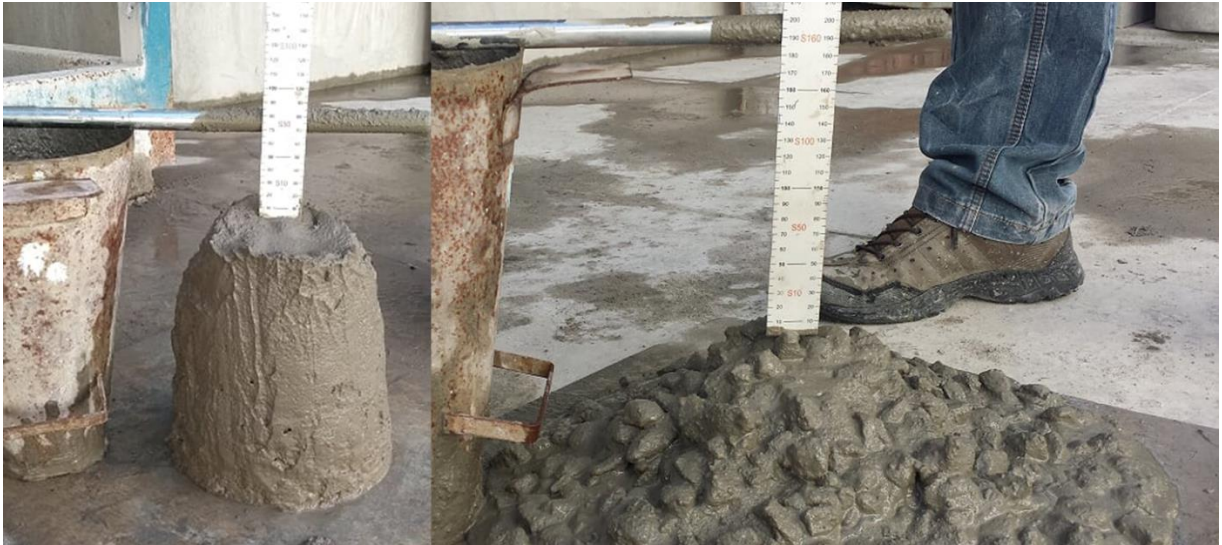
Figura 22 - Aferição do Slump Test para T2 e T3.
