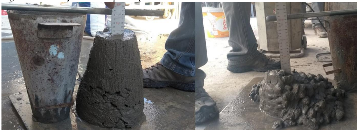
Figura 21 - Aferição do Slump Test para T0 e T1.
