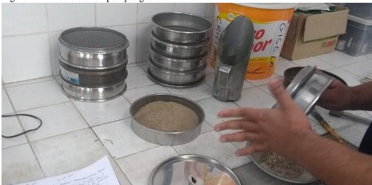
Figura 11 - Ensaio de composição granulométrica.
