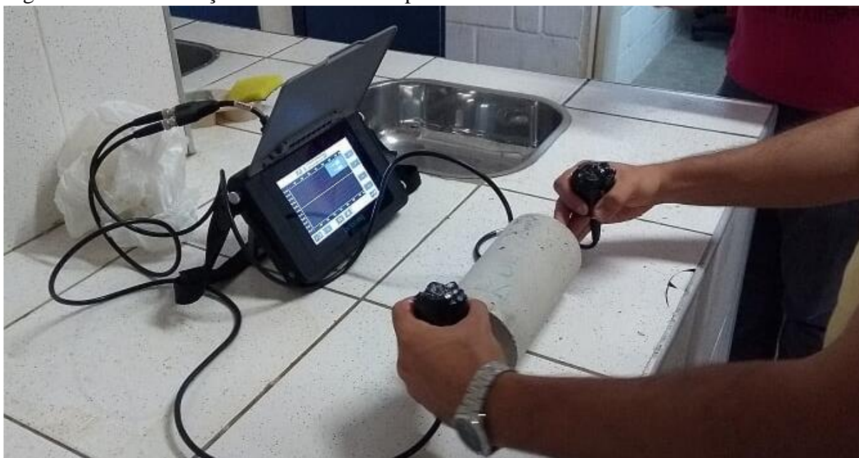
Figura 14 - Determinação da velocidade do pulso ultrassônico.
