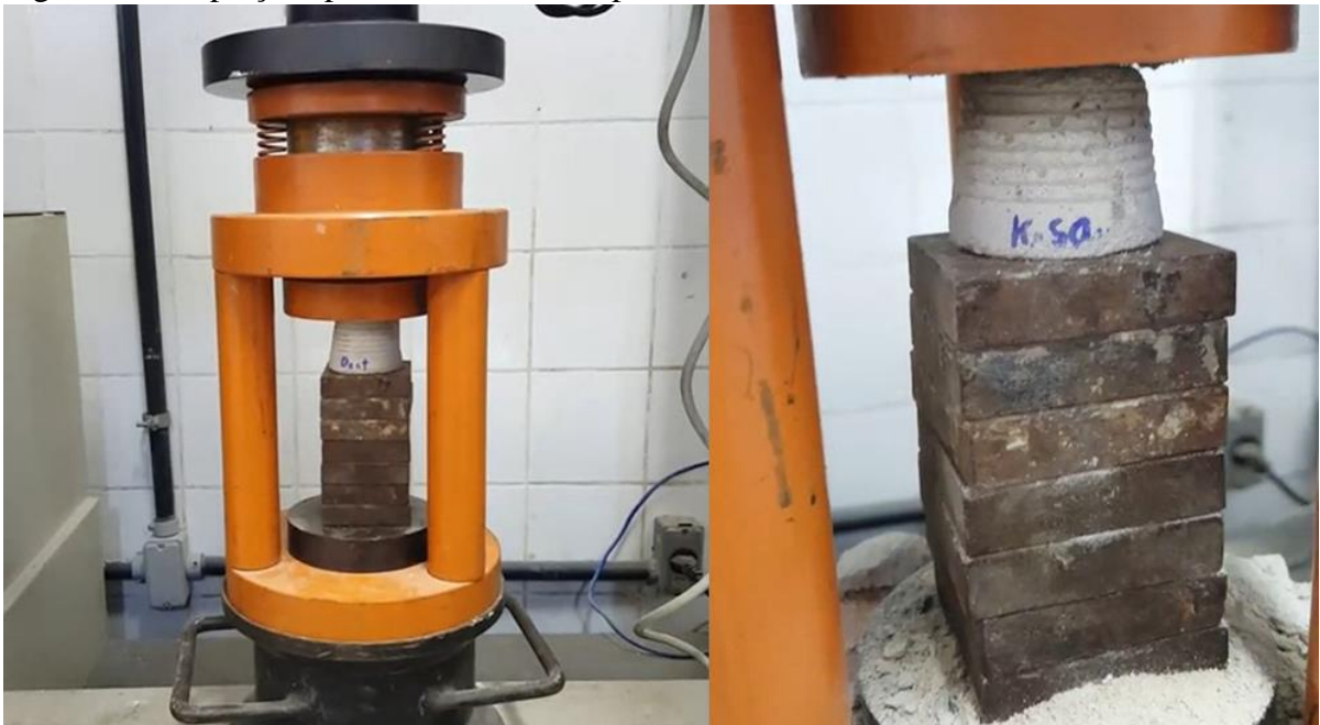
Figura 9 - Adaptações para resistência compressão.
