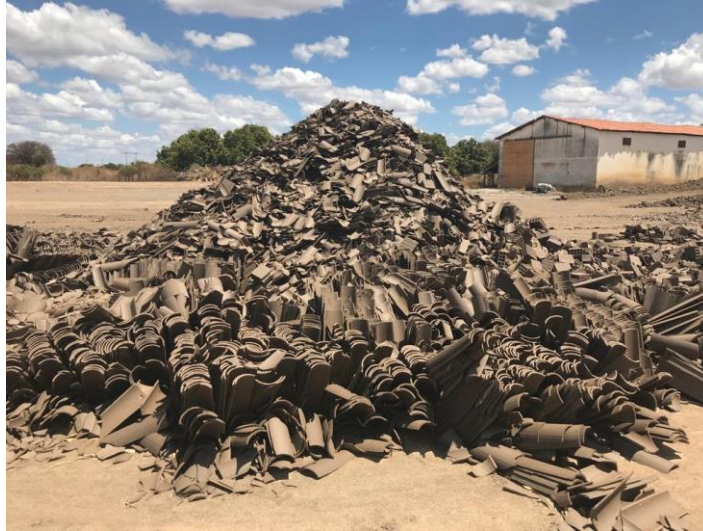
Figura 28 - Produtos defeituosos após o processo de secagem.
