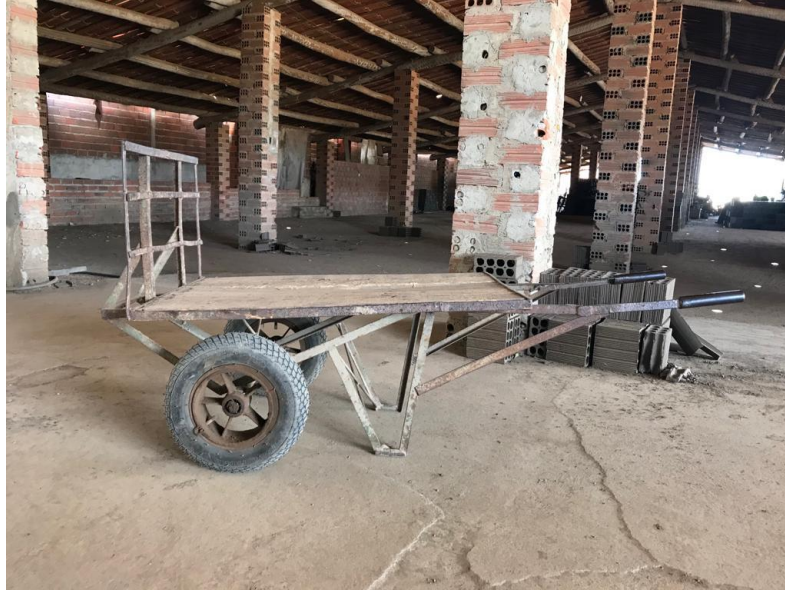
Figura 18 - Carrinhos manuais com dimensão 1,1m x 0,75m.
