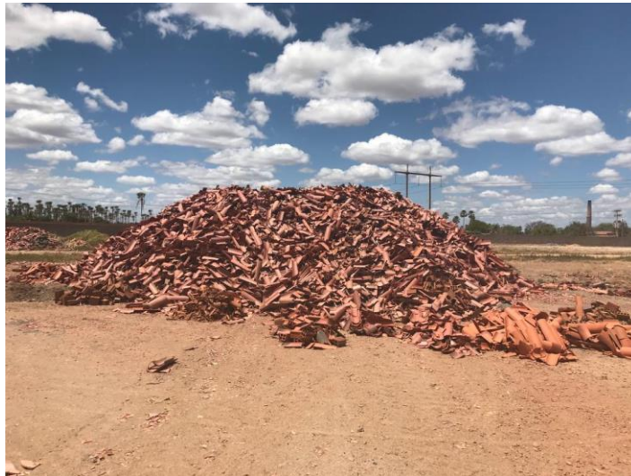
Figura 29 - Produtos defeituosos após o processo de queima.
