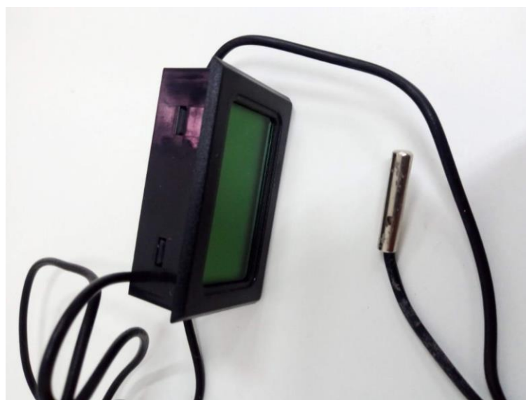
Figura 6: Termômetro de sonda utilizado para medições de temperatura.
