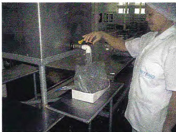
Figura 8. Processo de adição de água na embalagem do camarão “headless” na Indústria de Pesca do Ceará (IPECEA).
