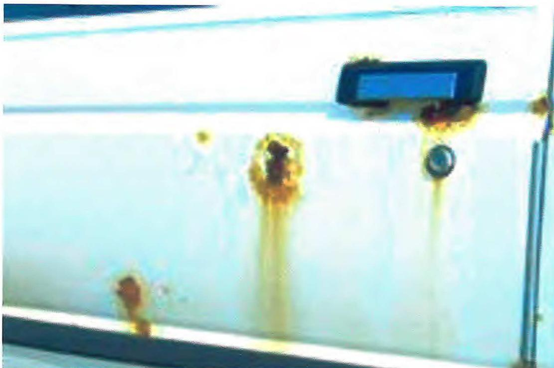
FIGURA - 2.8. Desgaste por corrosão.
