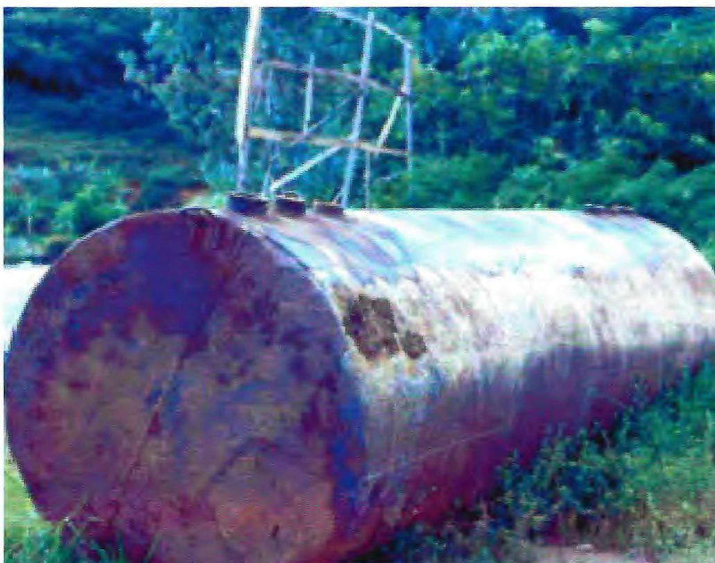
FIGURA - 2.7. Superfície sofrendo processo de corrosão.
