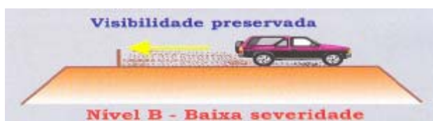
FIGURA 2.18: BAIXO NÍVEL DE SEVERIDADE – EXCESSO DE POEIRA (BAESSO & GONÇALVES, 2003)
