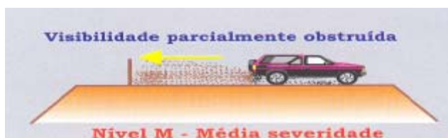
FIGURA 2.19: MÉDIO NÍVEL DE SEVERIDADE – EXCESSO DE POEIRA (BAESSO & GONÇALVES, 2003)
