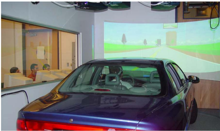
**Figura 3.2:** Simulador de condução de veículo, Universidade George Washington. Fonte: (CISR, 2003)
