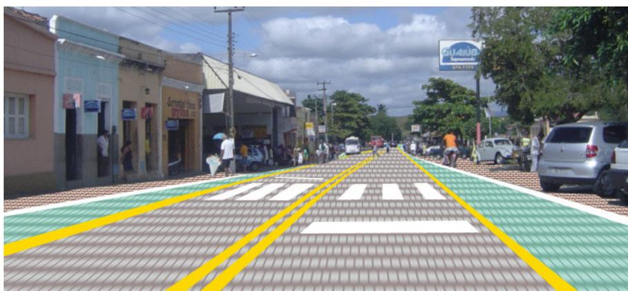
**Figura 5.14:** Faixa de pedestre na travessia, em pavimento intertravado
